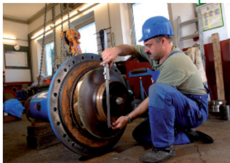
*Reparatur eines Laufrades einer horizontalen Pumpe.*
